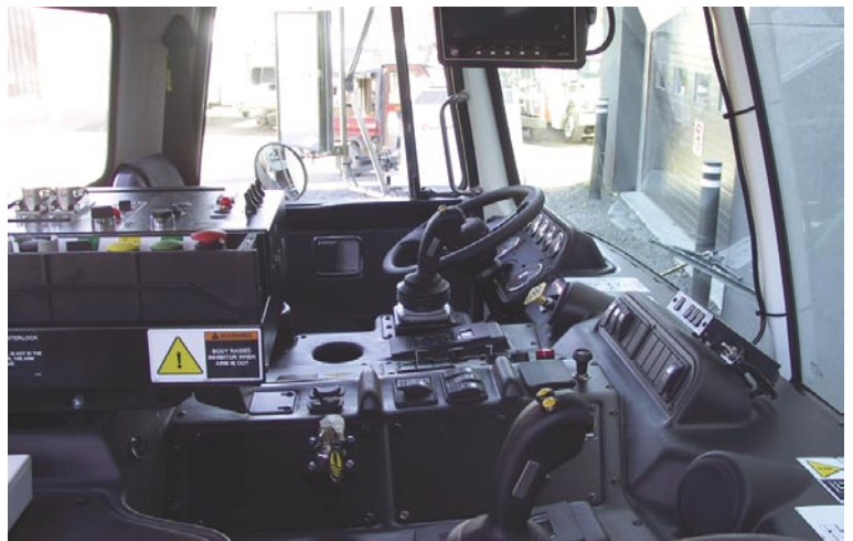
PHOTO 1 MANETTE DE COMMANDE AJUSTABLE ET VOLANT INCLINÉ À 15°
