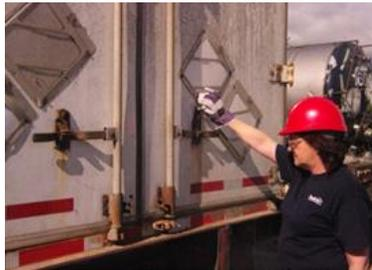
2 – Appuyer votre main gauche sur la porte et, de la main droite, soulever et faire pivoter la tige de verrouillage vers la gauche en suivant le mouvement de rotation.
