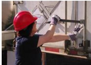
3 – La tige en fin de course et la porte déverrouillée, tirer la porte vers l'extérieur en vous plaçant sur le côté. À une ouverture d'environ 90°, passez de l'autre côté.
